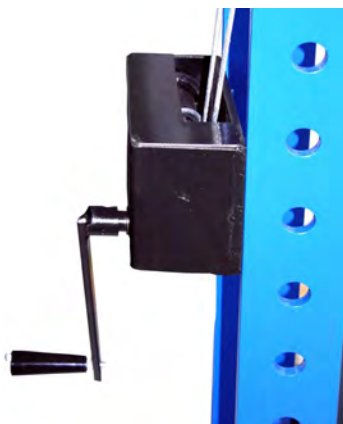
Obr. 9: Nastavení výšky stolu
